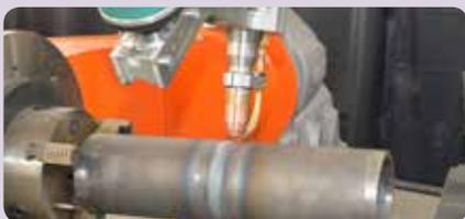
Verbindungen Rohr-Rohr oder Rohr-Flansch
