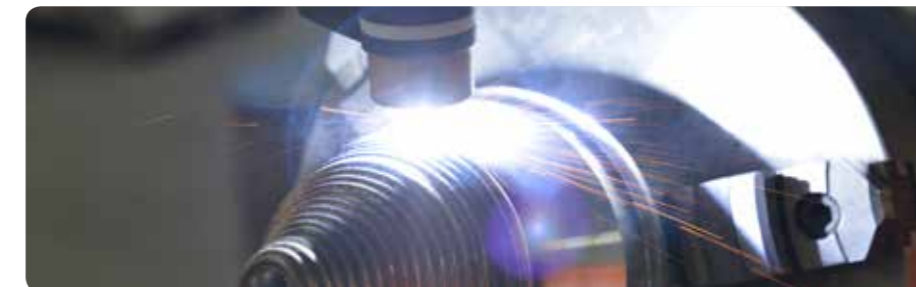
Beschichten eines Bohrkopfes mit Plasma | Hardfacing of a drill head by plasma
