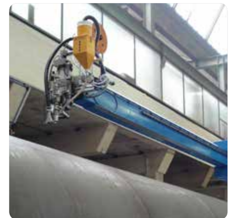
KA 2-UP: UP-Eindraht-Schweißkopf am Schweißmast für Innen- und Außennähte an großen Rohren | SA-single wire welding head at column and boom for inner and outer seams at large tubes
