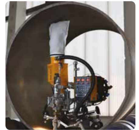
KA 1-UP: Automat in lenkbarer Ausführung für das Schweißen konischer Rohre | Automat as steerable version for welding of cone-shaped tubes
