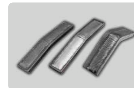
Schweißproben mit unterschiedlichen Pulvern und Schweißparametern | Weld tests with different fluxes and welding parameters
